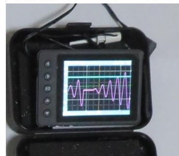
簡易オシロスコープで回路の動作確認を行い不良箇所を見分ける* 助成金で購入
