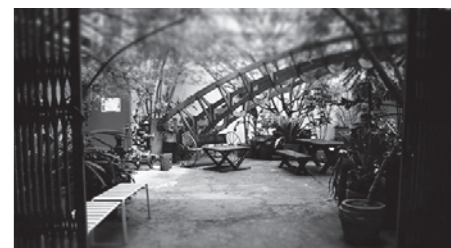
中庭は、築50年超の簡易宿泊施設の建物一部を削り、火災時の延焼や類焼の影響を防止する空間に変わった。
